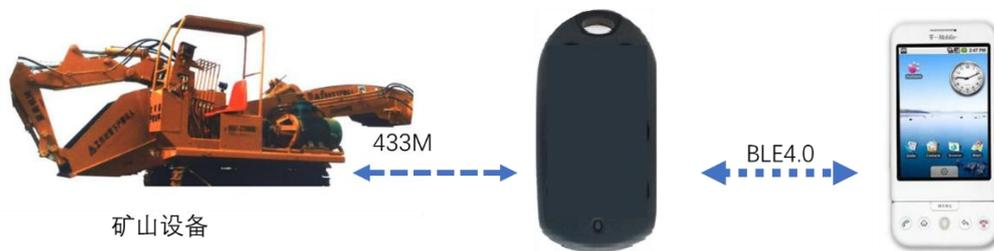
在野外作业时，移动通讯公司的基站信号往往无法覆盖到，或者信号质量不佳。采用我们的设备和手机 APP，就可以通过射频链路，直接读取设备数据或者控制设备。
